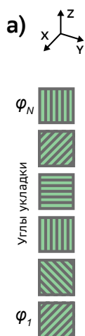
Диаграмма слоистого композиционного материала, состоящего из множества слоев, ориентированных в разных направлениях
